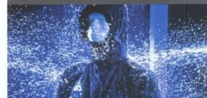
Test deštěm Průběžný test vodonepropustnosti oděvu Sympatex.
