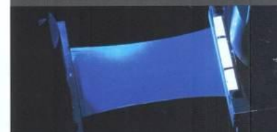
Trhací test Membrána Sympatex je průtažná až do 300%.
